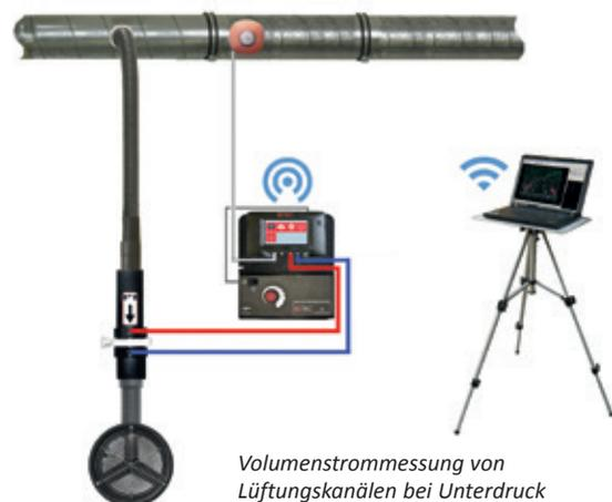
*Volumenstrommessung von Lüftungskanälen bei Unterdruck*
