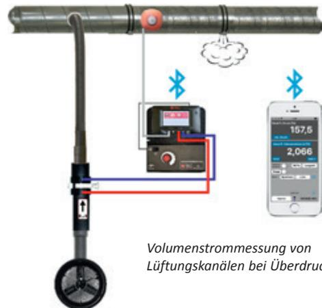
*Volumenstrommessung von Lüftungskanälen bei Überdruck*
