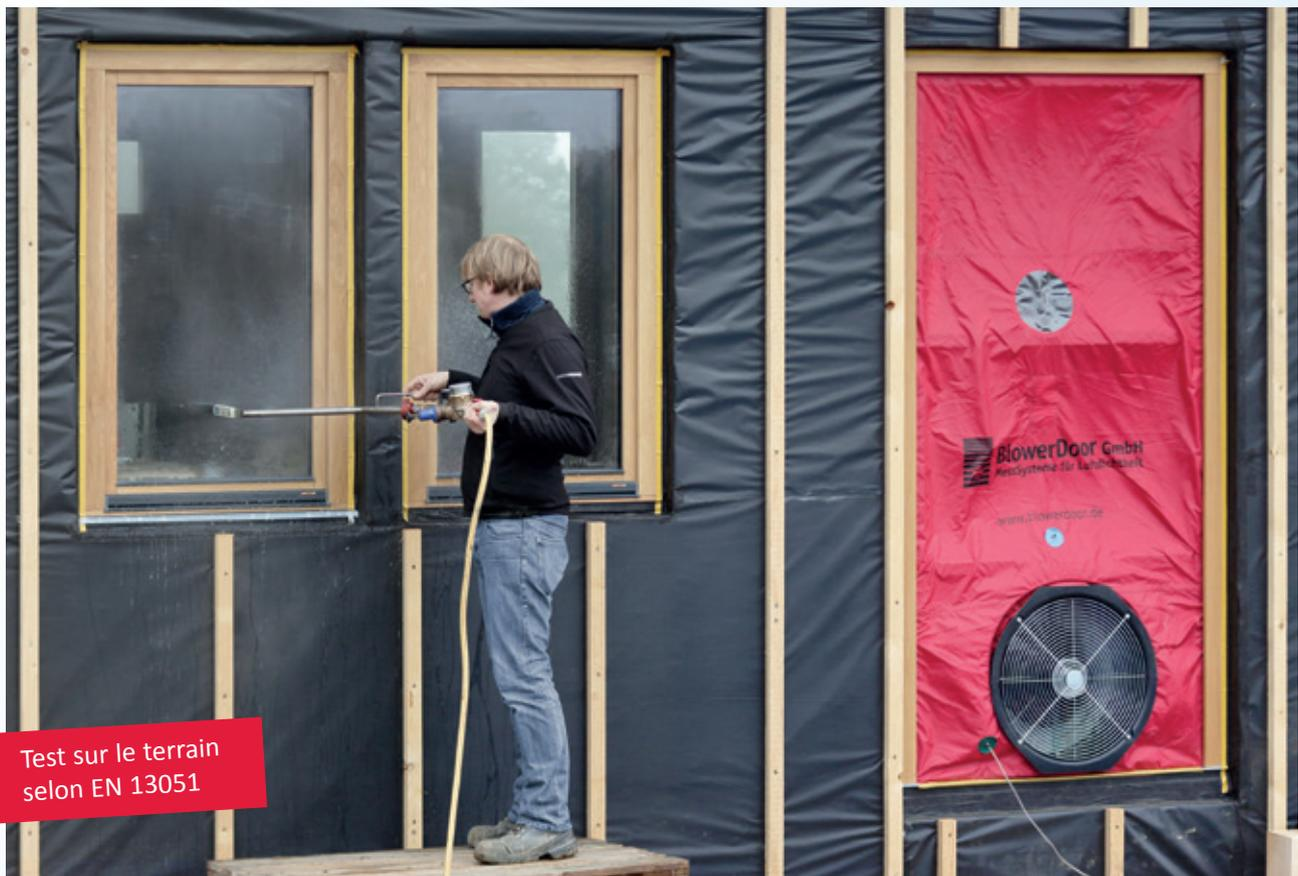
La SPRAY BAR est appropriée pour la détection de fuites plutôt importantes dans les murs-rideaux, conformément à la norme EN 13051 et pour tester l'installation des fenêtres, portes-fenêtres et portes extérieures ainsi que les extensions extérieures.
